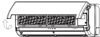
**SETZEN SIE DAS GERÄT NICHT OHNE FILTER IN BETRIEB!**
