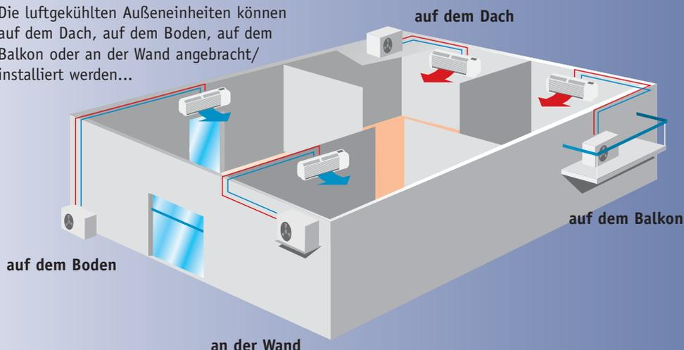
Der breite Leistungsbereich der HAWAI-Wandklimageräte ermöglicht die Klimatisierung unterschiedlichster Raumgrößen.
