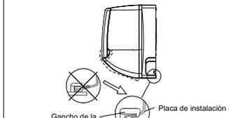
Para extraer la unidad, tire [ ] de la marca en la parte inferior de la unidad hacia usted para desenganchar los ganchos de la unidad.
