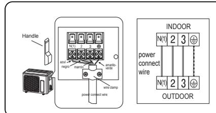
4. Asegure el cable multipolar con el sujetador de cables.
