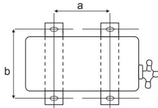
2. Per l'installazione sul tetto, tenere in considerazione vento e terremoti. Fissare l'unità con bulloni o chiodi.
