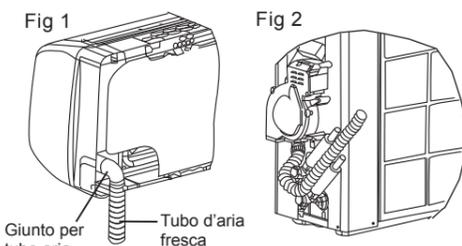
1. Collegare il giunto del tubo d'aria all'unità interna
