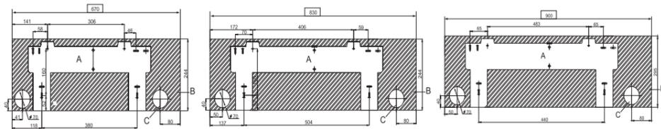
A: Panel de instalación B: Esquema de la unidad interna (panel de cartón) C: Apertura sobre la pared para la tubería
