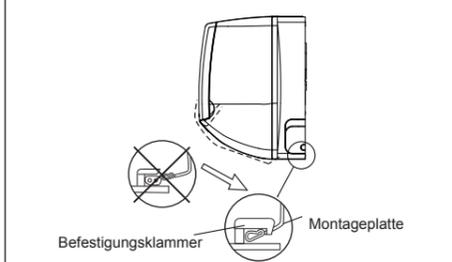
Um das Gerät herauszuheben, ziehen Sie bei der Markierung unten am Gerät leicht in Ihre Richtung, um die Haken vom Gerät loszulösen.
