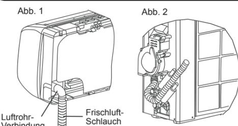
Dieses Gerät ist mit einem 5m langen Frischluft-Schlauch ausgestattet. Falls nötig, kann der Schlauch von einem professionellen Installateur mit einem zusätzlichen Schlauch verlängert werden. Benutzen Sie den Schlauchbogen und die Klemmen, um das schmalere Ende (ø30) des zusätzlichen Schlauchs mit dem Originalschlauch zu verbinden und befestigen Sie das andere Ende mit Hilfe der Klemme des Außenschlauchs (ø30) an der Anschlussstelle des Propellorgehäuses. (Siehe Darstellung unten)
