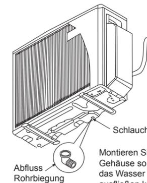
Montieren Sie das Gehäuse so, dass das Wasser ruhig ausfließen kann.
