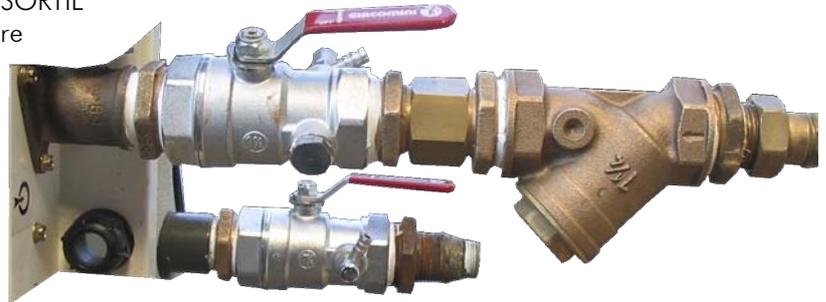
L'appareil est fourni avec un sous ensemble filtre à eau avec vanne d'isolement. Raccorder à l'unité ce sous ensemble en veillant à maintenir vers le bas le tamis du filtre à eau.
