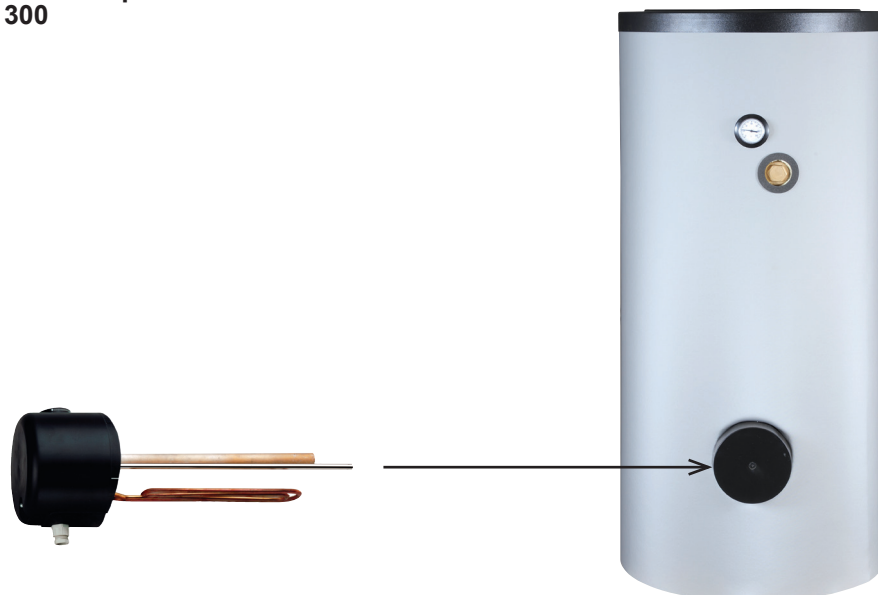
Einbau in Trinkwasserspeicher DW 300
