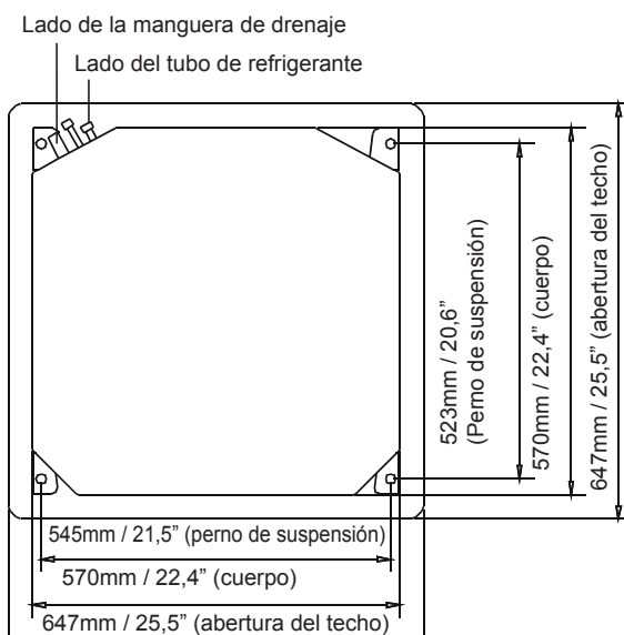
Tamaño del agujero de techo para modelos compactos
