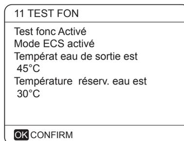
Pendant le test de fonctionnement en MODE ECS, la température cible de l'eau sanitaire par défaut est de 55°C. Le TBH (réchauffeur d'appoint du réservoir) s'allumera après le fonctionnement du compresseur pendant 10 minutes. Le TBH s'éteindra 3 minutes plus tard, la pompe à chaleur fonctionnera jusqu'à ce que la température de l'eau augmente à une certaine valeur ou que la prochaine commande soit reçue.
