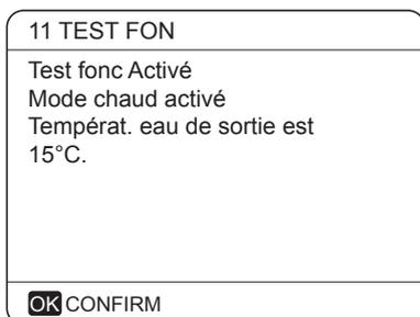
Pendant le test de fonctionnement en MODE CHAUD, la température cible de sortie d'eau par défaut est de 35°C. L'IBH (le réchauffeur de secours interne) s'allumera après le fonctionnement du compresseur pendant 10 min. Après que l'IBH ait fonctionné pendant 3 minutes, l'IBH s'éteindra, la pompe à chaleur fonctionnera jusqu'à ce que la température de l'eau augmente à une certaine valeur ou que la prochaine commande soit reçue.
