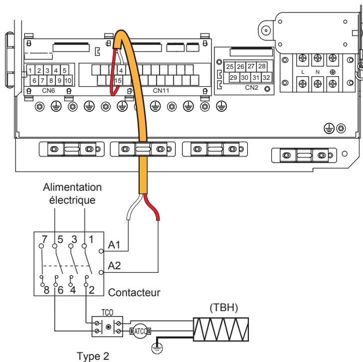
Port de signal de contrôle du modèle hydraulique: Le **CN11/CN2** contient des bornes pour l'énergie solaire, l'alarme à distance, la vanne 2 voies, la vanne 3 voies, la pompe, le réchauffeur d'appoint, la source de chauffage externe, etc.
