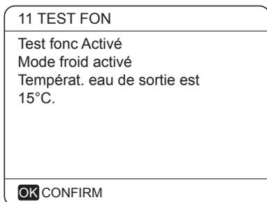
Pendant le test de fonctionnement en MODE FROID, la température cible de sortie de l'eau par défaut est de 7°C. L'unité fonctionnera jusqu'à ce que la température de l'eau tombe à une certaine valeur ou que la prochaine commande soit reçue.
