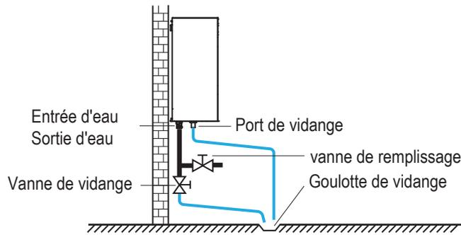
Lorsque l'eau est immobile à l'intérieur du système, le gel est très susceptible de se produire, ce qui endommagera le système dans le processus.
