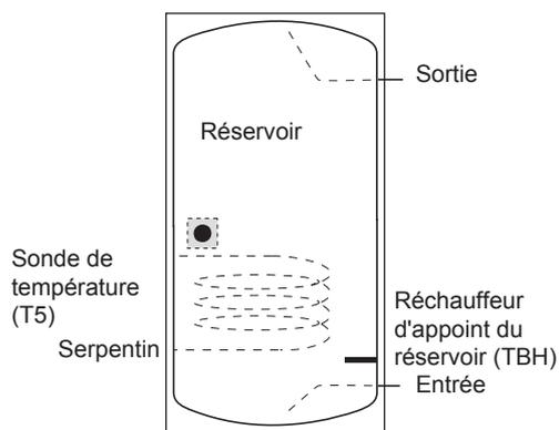
Le réchauffeur d'appoint doit être installé sous la sonde de température (T5).
