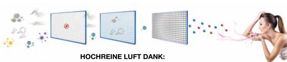
**HOCHREINE LUFT DANK:**HEPA- und Kalt-Katalysator-Filter: **Staub-** und Feinstaubfilter.Aktivkohlefilter: **Lufterfrischer.**Silberionenfilter: **antibakteriell.****OPTIONEN**
