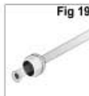
Fig. 19 Per prevenire fughe di refrigerante è bene unte le filettature con olio di refrigerazione
