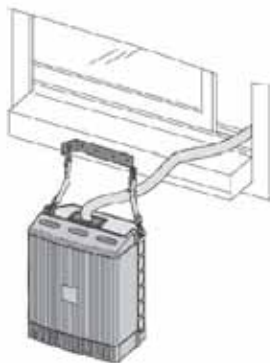
Abbildung 5. Montage des Außenteils an der Fensterbank
