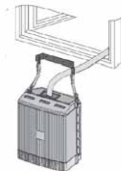
Abbildung 6. Montage des Außenteils an der Wand
