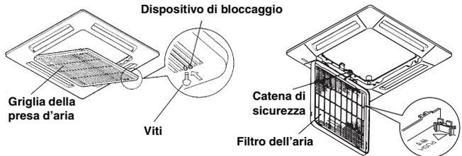
Tipo con montaggio a soffitto
