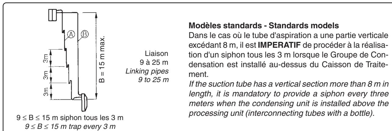
La charge en R22 est contenue uniquement dans le caisson extérieur. Les unités intérieures contiennent une petite quantité de gaz neutre. C'est pourquoi après avoir installé les liaisons il faut **impérativement** tirer au vide les liaisons et les 2 unités intérieures (voir notice d'installation).
