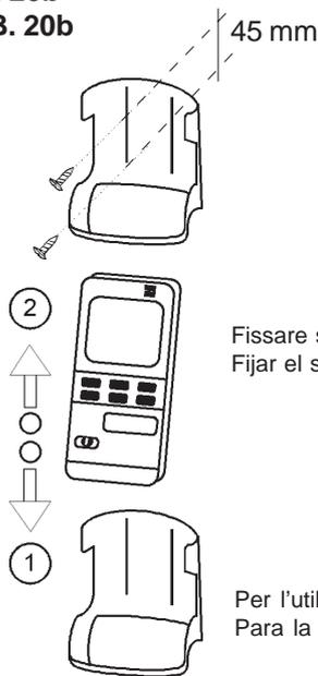
Fissare sulla parete il supporto del comando a distanza mediante le 2 viti fornite.
